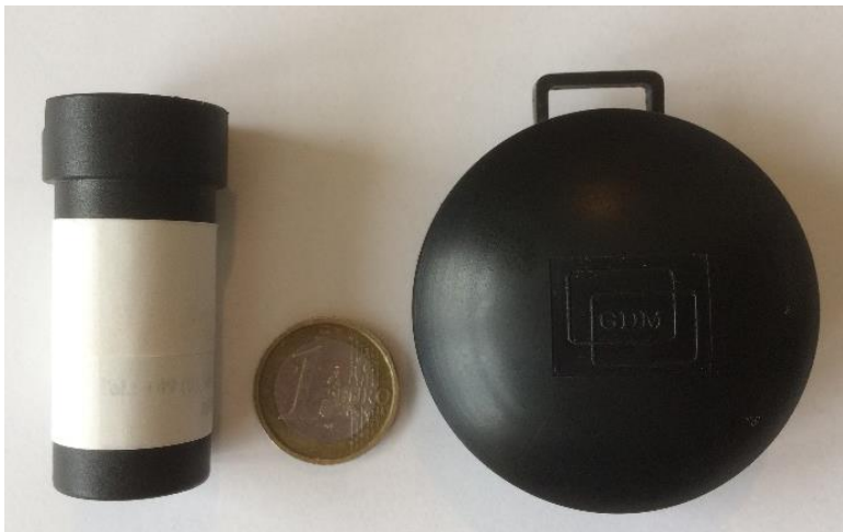
Radon-Detektoren unterschiedlicher Hersteller im Größenvergleich mit einer Münze
